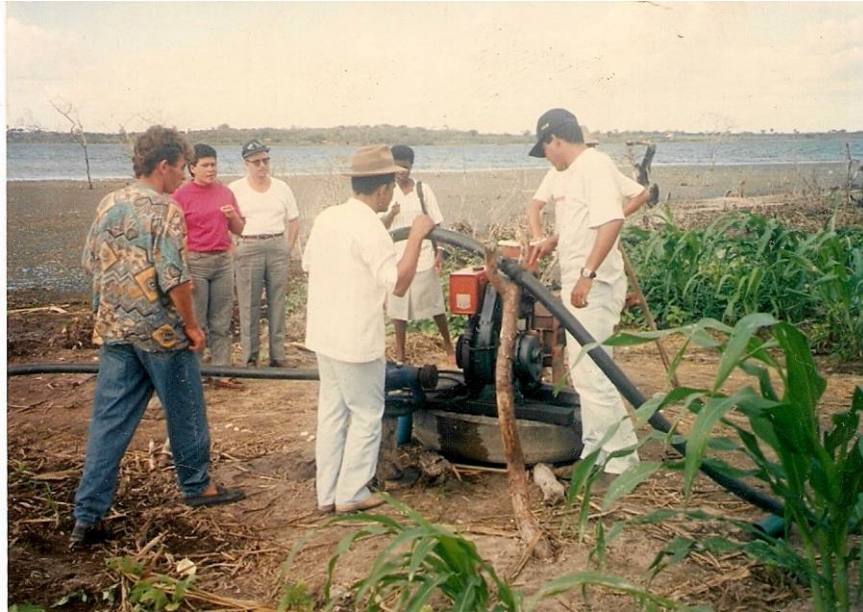
Foto 2 – Motor-bomba para irrigação da primeira roça Fonte: Acervo particular da APPJ.
