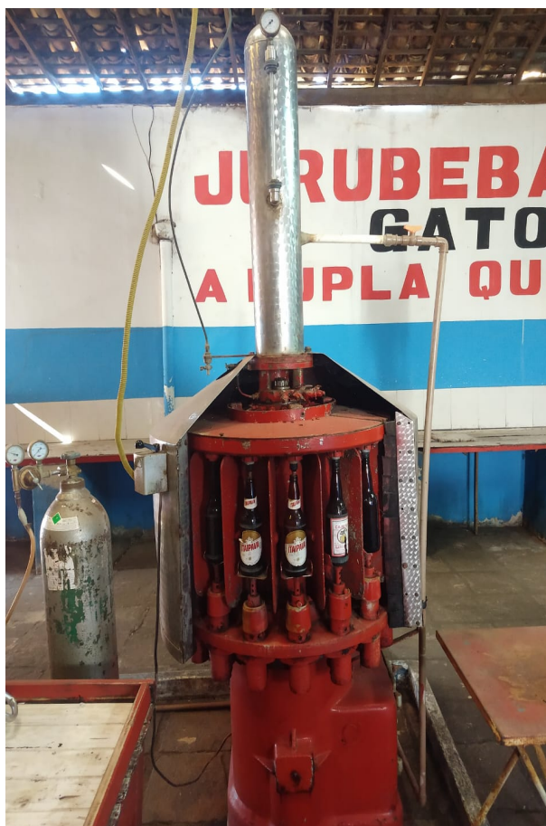
Figura 3: Máquina de rotular e encher garrafas
