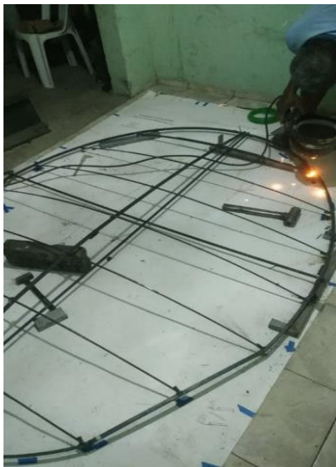
Figura 25. Fabricação do refletor do concentrador solar tipo Scheffler.
