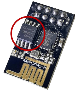
(b) Memória Flash W25Q80B de 8Mb integrado ao módulo WiFi ESP8266
