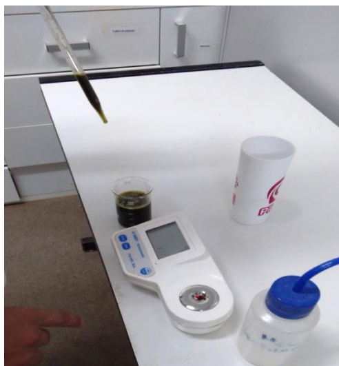
Figura 8- Determinação dos valores de sólidos solúveis em laboratório do Campus IX da Universidade do Estado da Bahia. (Foto: Teixeira, J.S.) Barreiras- Ba, 2018
