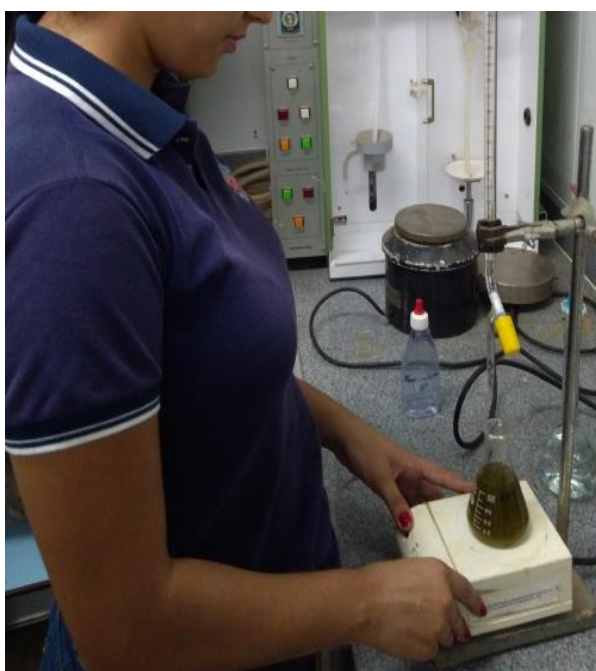
Figura 10- Determinação dos valores de acidez titulável em laboratório do Campus IX da Universidade do Estado da Bahia. (Foto: Teixeira, J.S.) Barreiras- Ba, 2018
