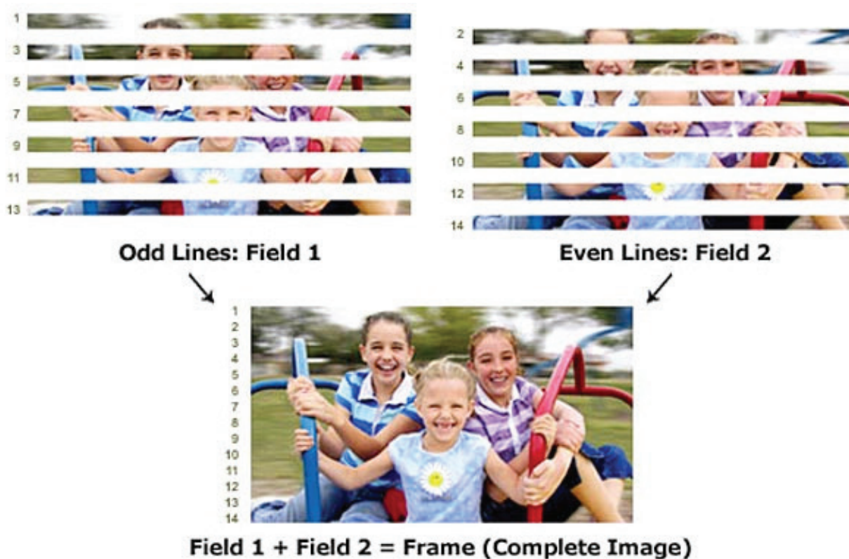
Figura 7 – Sistema de varredura (formação) da imagem
