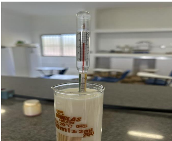
Figura 3. Teste de densidade com densímetro de Quevenne. Fonte: Autores (2025).
