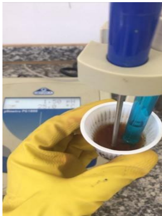
2 – nivelamento do pH do sobrenadante. SOUZA, I. O. S. 2020.
