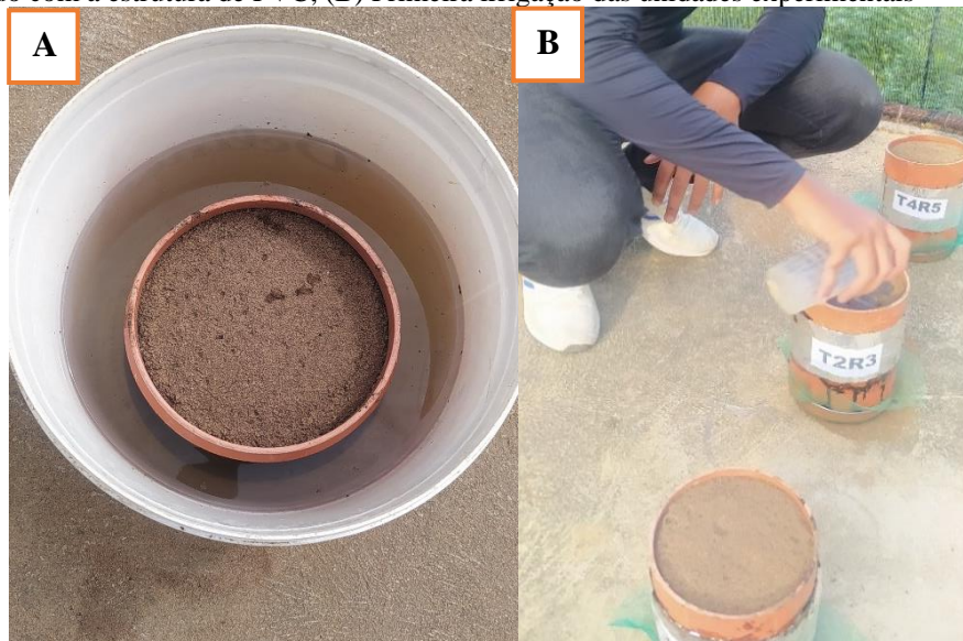
Figura 7. Metodologia usada para irrigar as unidades experimentais. (A) Teste de capacidade de campo-CC realizado com a estrutura de PVC; (B) Primeira irrigação das unidades experimentais
