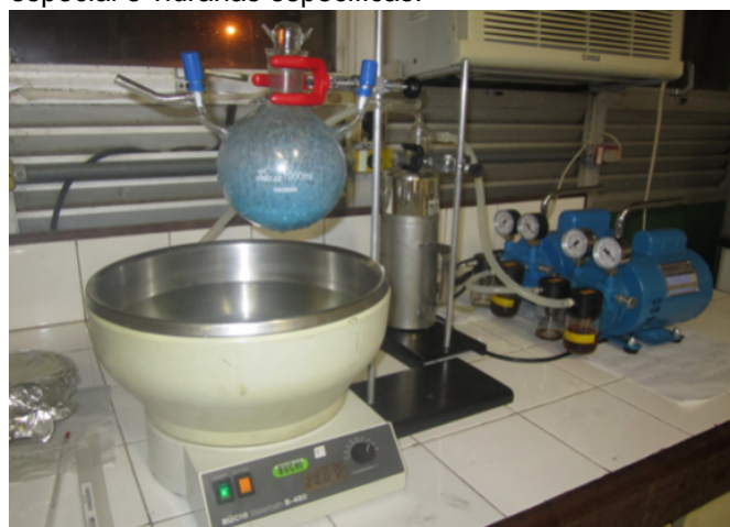
Figura 1. Sistema para a obtenção dos óxidos com estrutura Perovskita, equipado com reator de vidro pyrex.
