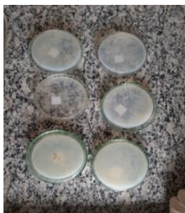
Figura 2. Degradação de polipropileno em placas com meio mínimo.
