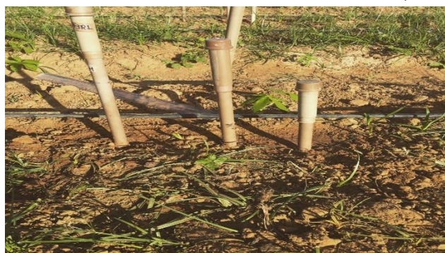
Figura 3. Detalhe de tensiômetros instalados no estudo com mandioca, em Juazeiro-BA.
