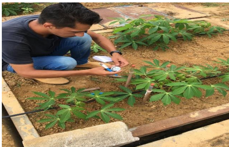
Figura 4. Detalhe da leitura das tensões da água no solo, estudo com mandioca, em Juazeiro-BA.
