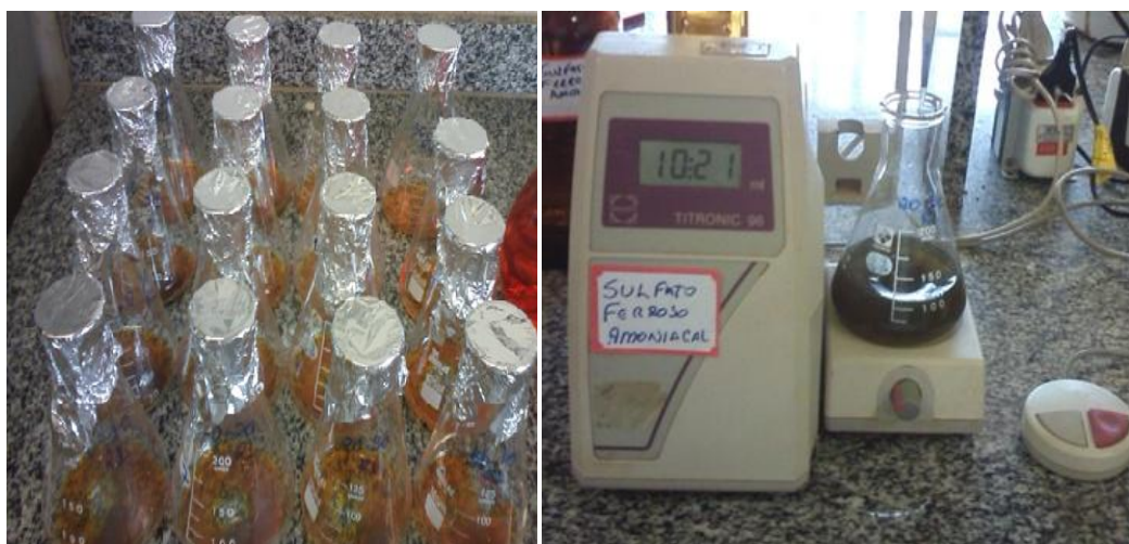
Figura 5: (A e B): Amostras de solo com dicromato de potássio (A) e sendo tituladas com sulfato ferroso amoniacal (B).
