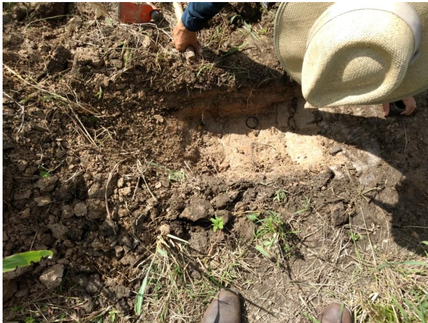
Figura 2. Coleta de amostras indeformadas de solo.
