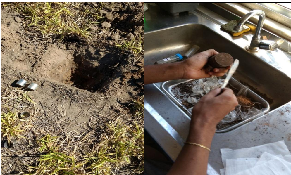
Figura 3: (A e B): Coleta e amostras de solo indeformadas para análise da densidade do solo, macroporosidade e microporosidade.
