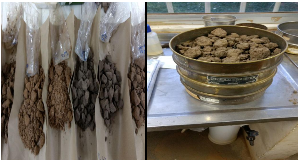
Figura 4: Amostras de agregados sendo secas ao ar (a) e o conjunto de peneiras utilizado (b).
