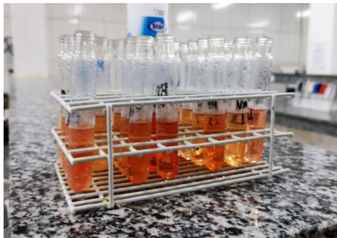
Figura 10. Amostras retiradas do banho maria para a determinação de prolina.
