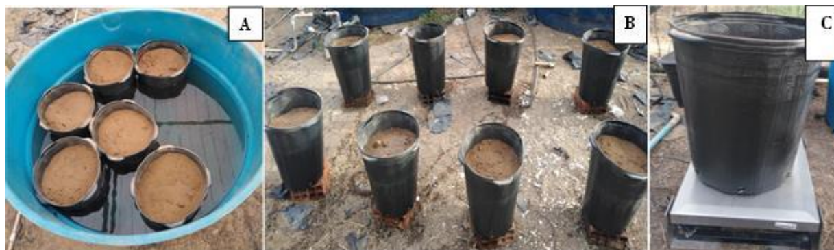
Figura 5. Vasos preenchidos com o solo e colocados para saturar (A), drenagem natural (B) e pesagem do solo em balança de precisão (C).
