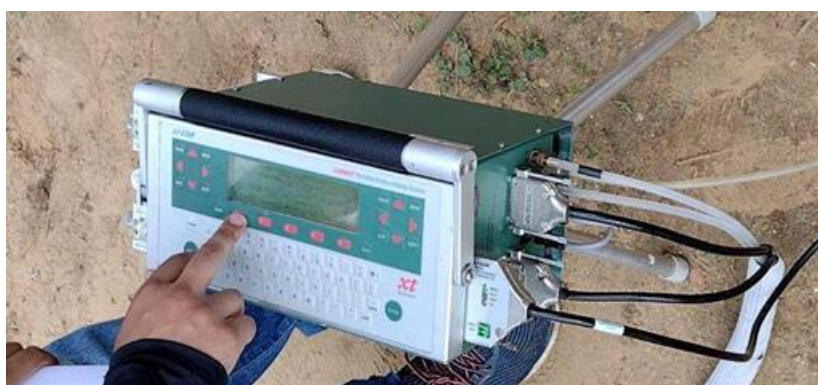
Figura 10. Analisador portátil de gás infravermelho (IRGA - InfraRedGasAnalyser ). Juazeiro, BA, 2021.
