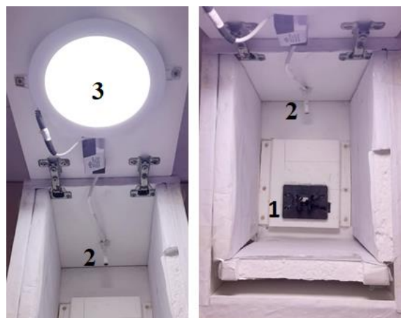
Figura 15: Sistema de aquisição de imagens (vista interna). (1) Porta cubeta; (2) Câmera microscópica; (3) Lâmpada de led .
