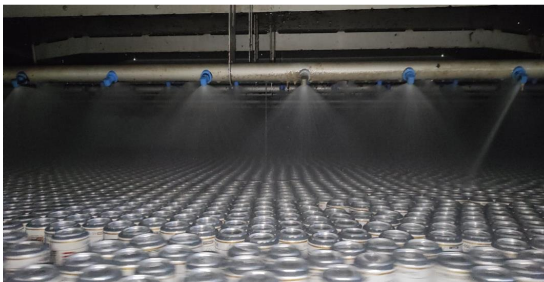
Figura 6 – Imagem interna do pasteurizador em funcionamento.
