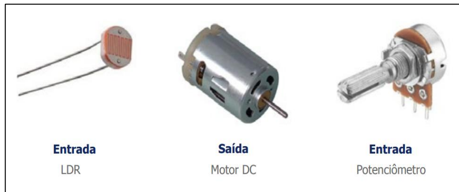
Figura 18 - Exemplos de sistemas eletrônicos de entrada/saída analógicos.
