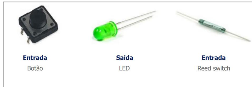
Figura 17 - Exemplos de sistemas eletrônicos de entrada/saída digital.
