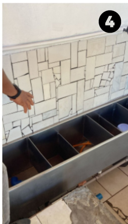
(4) Compartimento de separação do caldo e bagaço da cana-de-açúcar
