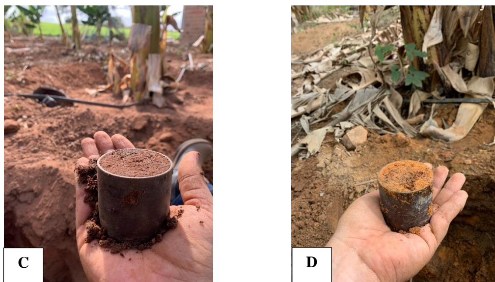
Figura 1. A- Área de coleta 01. B- Área de coleta 02. C- Amostra da área de coleta 04 no anel volumétrico. D- Amostra da área de coleta 03 no anel volumétrico.
