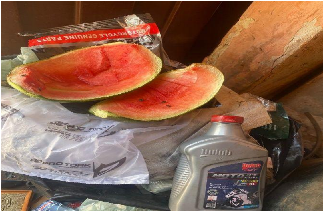
Figura 6 - Acondicionamento de resíduos na oficina P3, em saco de lixo juntamente com resíduos orgânicos, metais, borrachas.
