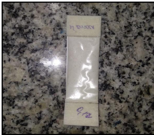
Figura 24. Corpos de prova na dimensão de 50 mm de comprimento e 25 mm de largura.
