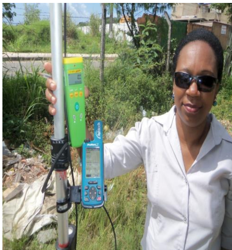
Figura 20 - Foto de medição do CO (PPM) em Canabrava/ aparelho medindo CO2
