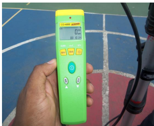
Figura 21 - Foto de medição do CO (PPM) em Canabrava/ aparelho medindo CO2
