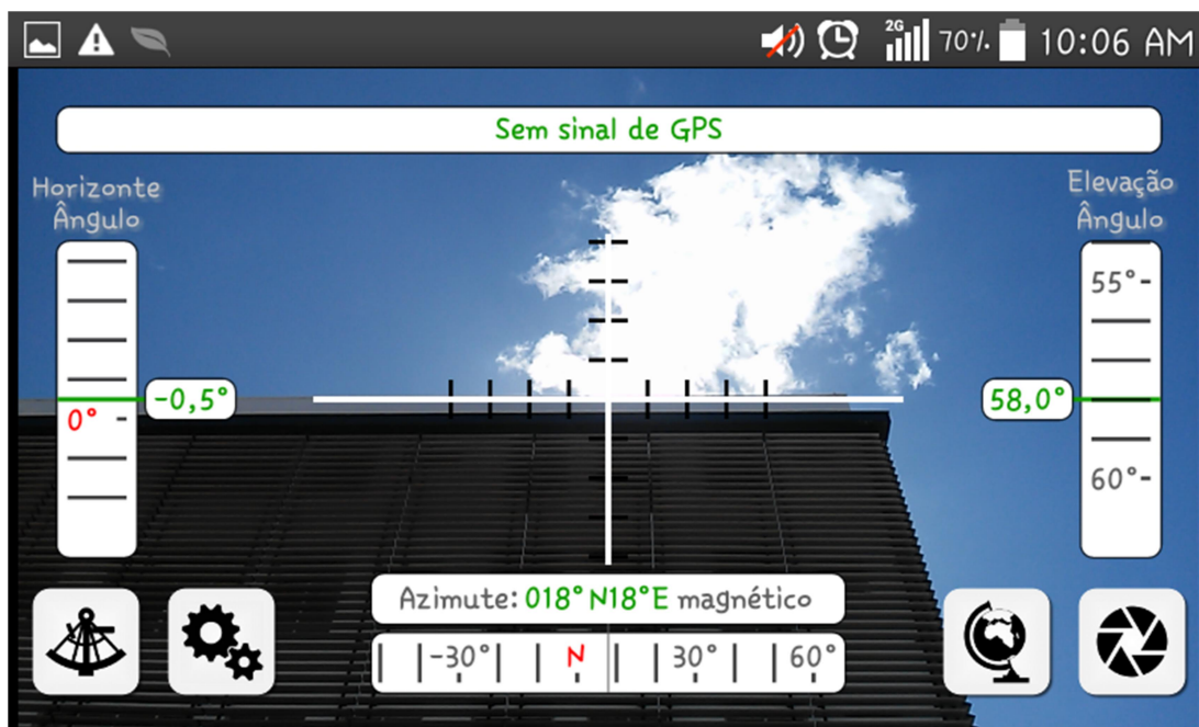
Figura 20 - Print screen do aplicativo, imagem da fachada do prédio do fórum, tirado pela pesquisadora coletando o ângulo para sua medida.
