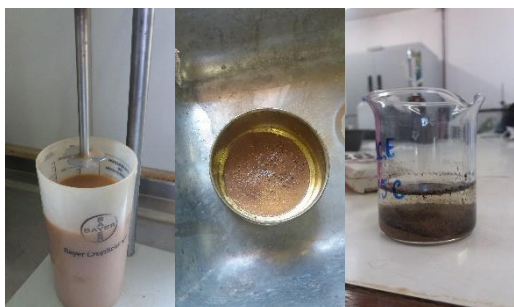
Figura 8. Amostra no dispersor de solo, na peneira e no béquer.
