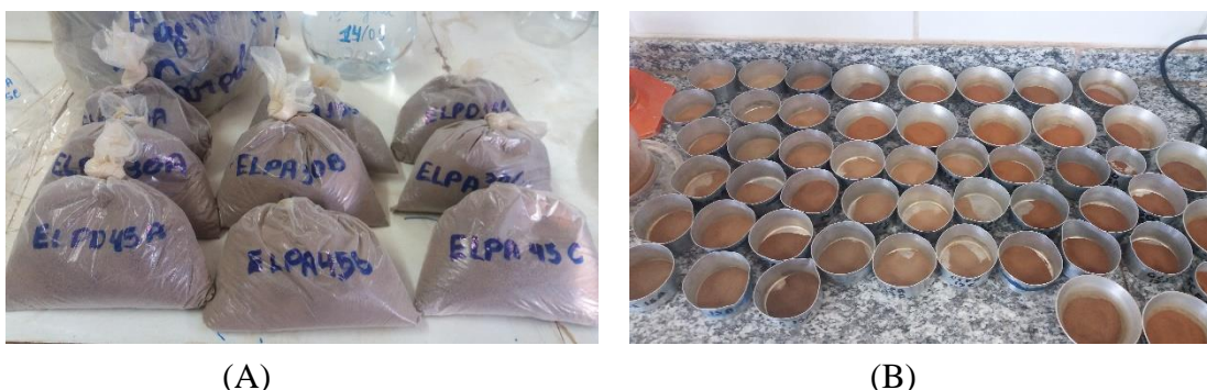
Figura 2. Amostras de solo separadas e identificadas para o fracionamento físico (A) e determinação de teores de carbono orgânico total (B).
