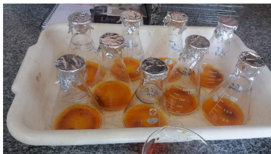
Figura 3. Amostras de solo com dicromato de potássio levado a estufa.
