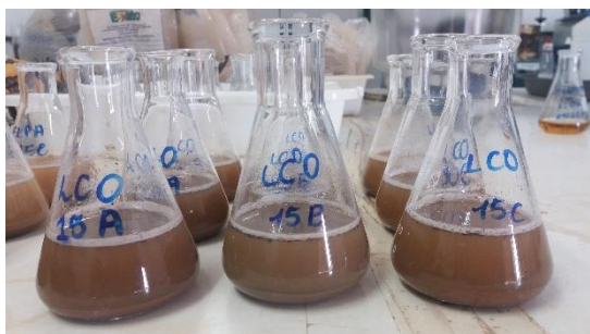
Figura 6. Amostra com Hexametáfosfato de sódio.
