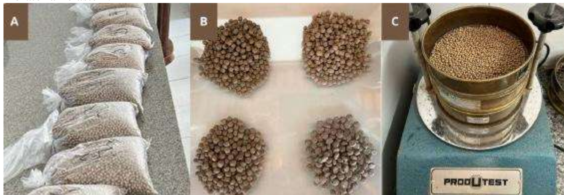
Figura 1. A. Rações adquiridas e classificadas por marca para realização de testes físicos; B. Análise de cor para detecção de pellets com coloração atípica; C. Avaliação de resistência física com ração na máquina vibratória Telastem.
