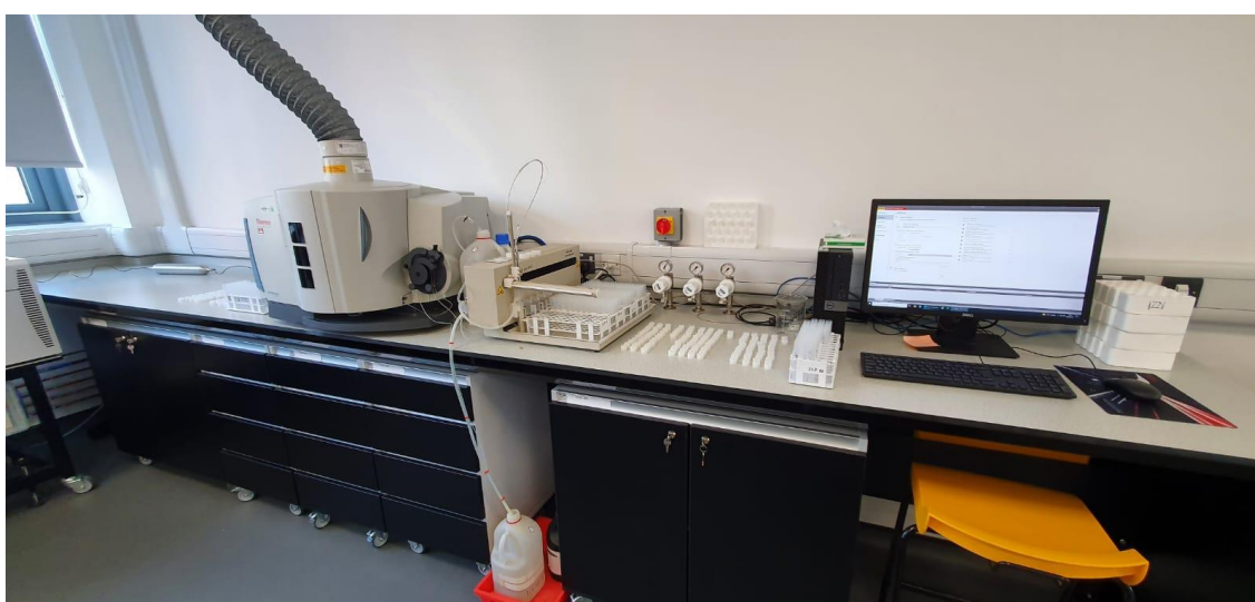
Figura 5. ICP-MS Espectrometria massa com plasma indutiva acoplado, no Laboratório da Universidade de Metropolitana de Manchester, Reino Unido.
