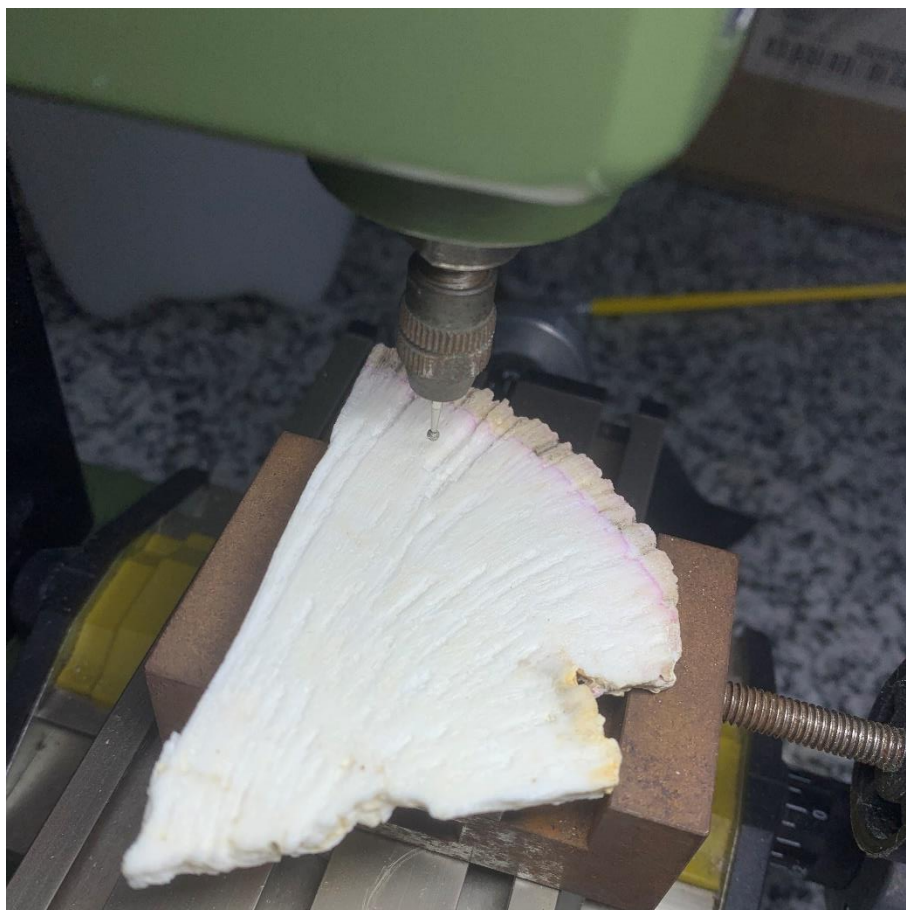
Figura 4. Microfuradeira (Micromill) com a amostra obtida de uma única parede de coralito da colônia de coral.
