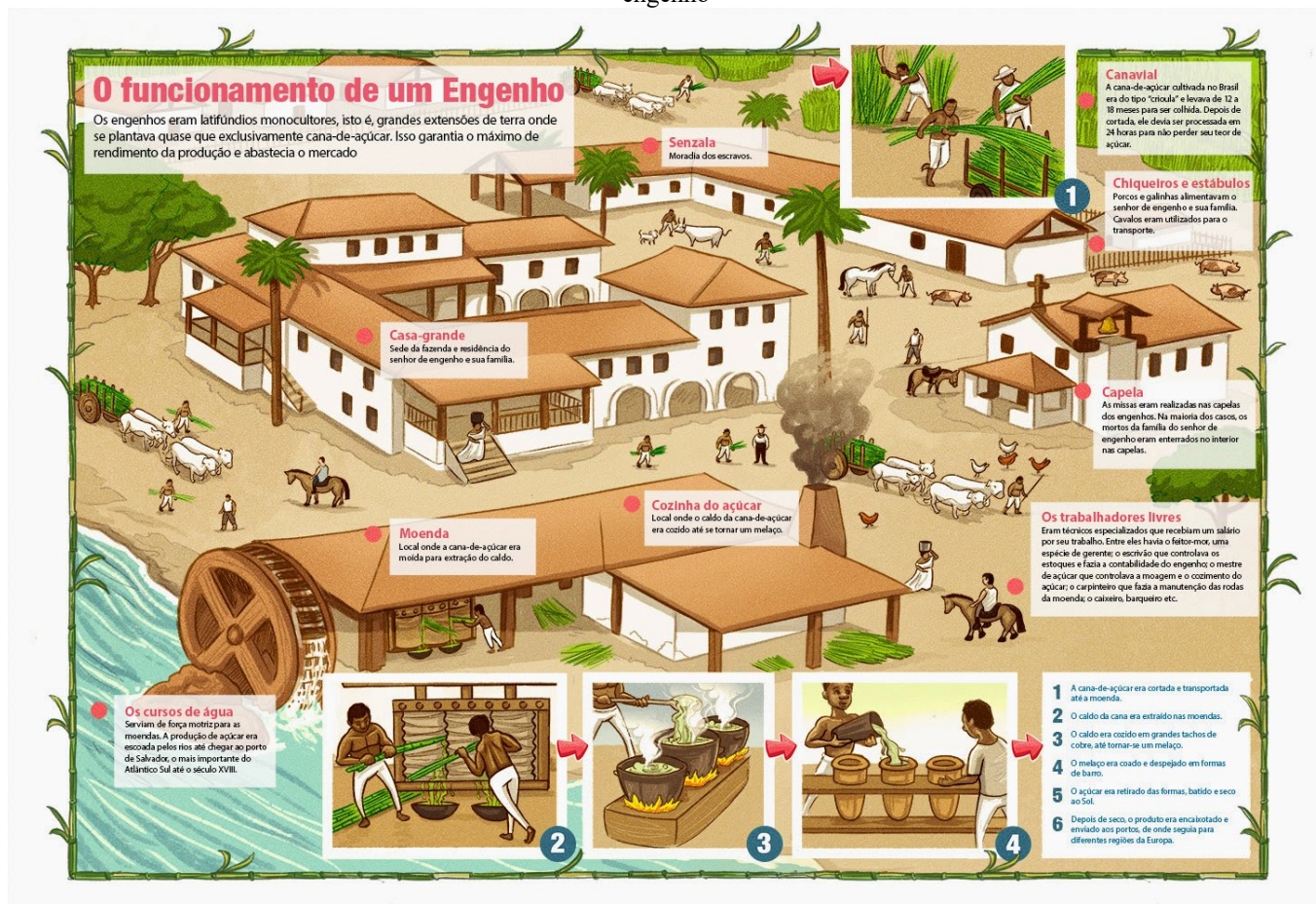
Figura 3 –Disposições e funções básicas das principais estruturas presentes em um engenho
