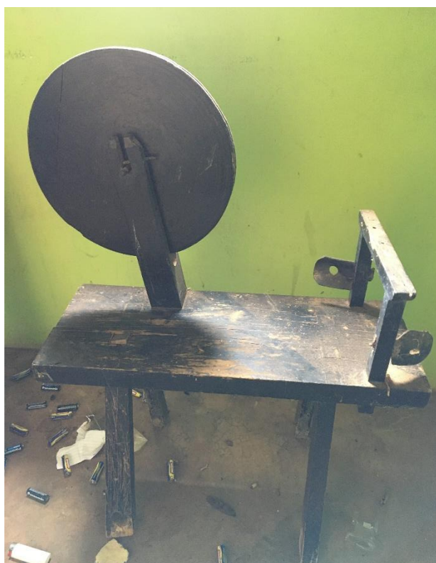
Foto 18 - Máquina de fiar - utilizada para transformar fibras têxteis de algodão, seda e lã em fio
