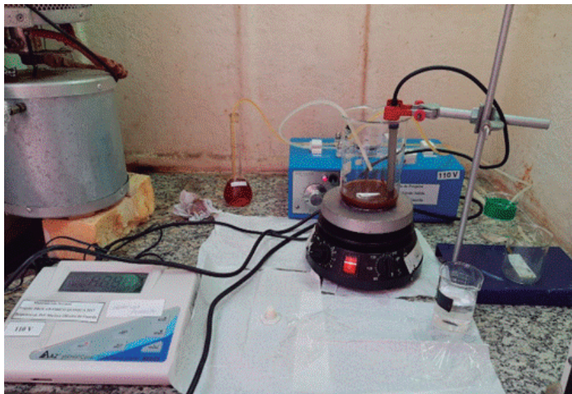
Figura 2 – Sistema utilizado nas sínteses por precipitação.
