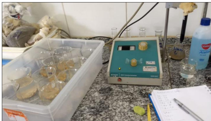
Figura 6. Condutividade elétrica nas temperaturas de 25° e 35°C, Barreiras – Ba, 2018.
