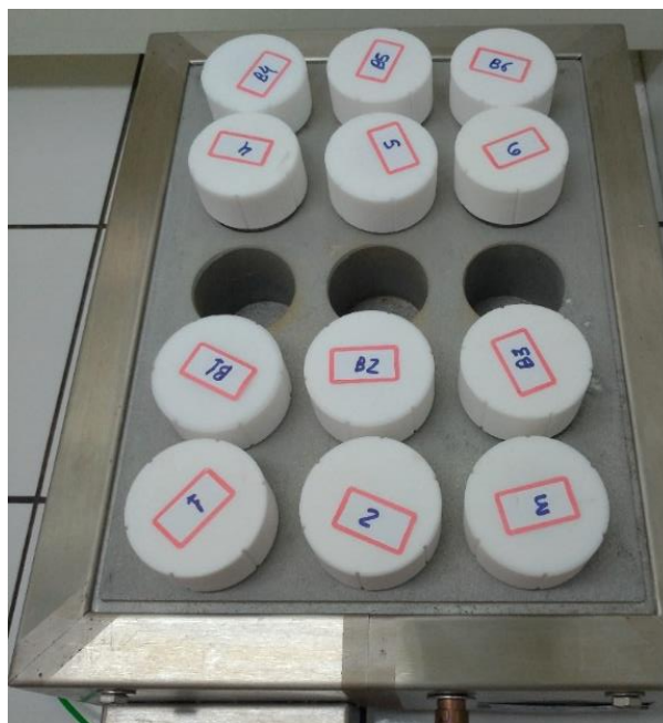
Figura 7. Digestão das amostras em bloco digestor e seus respectivos brancos nas condições (condição 8) ideais encontradas.
