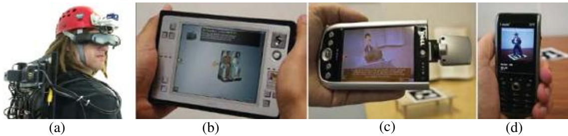
Figura 5: Dispositivos móveis executando realidade aumentada: (a) Típica mochila “móvel” com capacete HMD;(b) UMPC;(c) PDA;(d) Smartphone .
