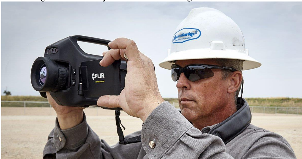
Figura 4 – Utilização da Câmera Termográfica FLLIR GF620
