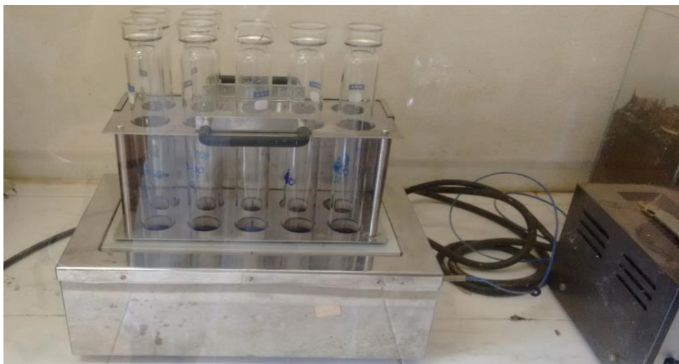
Figura 12. Preparo das amostras por digestão. Fonte: Autor, 2019
