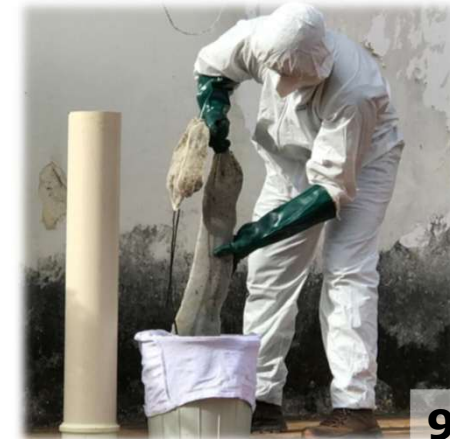
Extração do biofertilizante retido na massa orgânica dentro do filtro de tela
