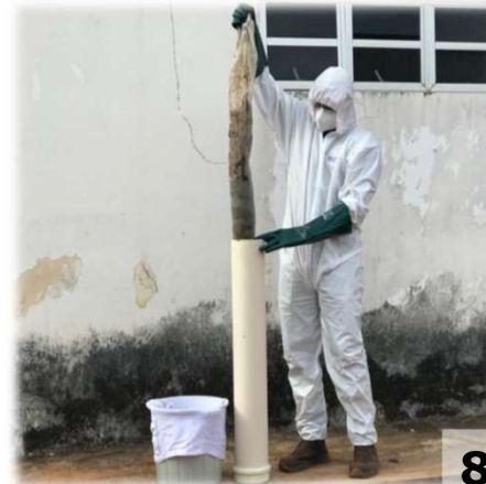
Remoção do filtro cilíndrico de tela em nylon da câmara de fermentação
