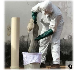
Extração do biofertilizante retido na massa orgânica dentro do filtro de tela
