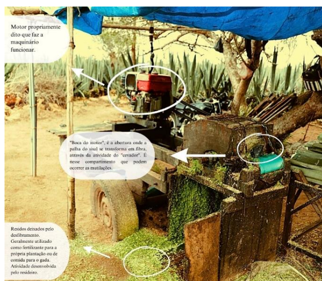
Imagem 1 – A Máquina Desfibradora, Conhecida como “Motor De Sisal”, Responsável pelo Desfibramento da Palha
