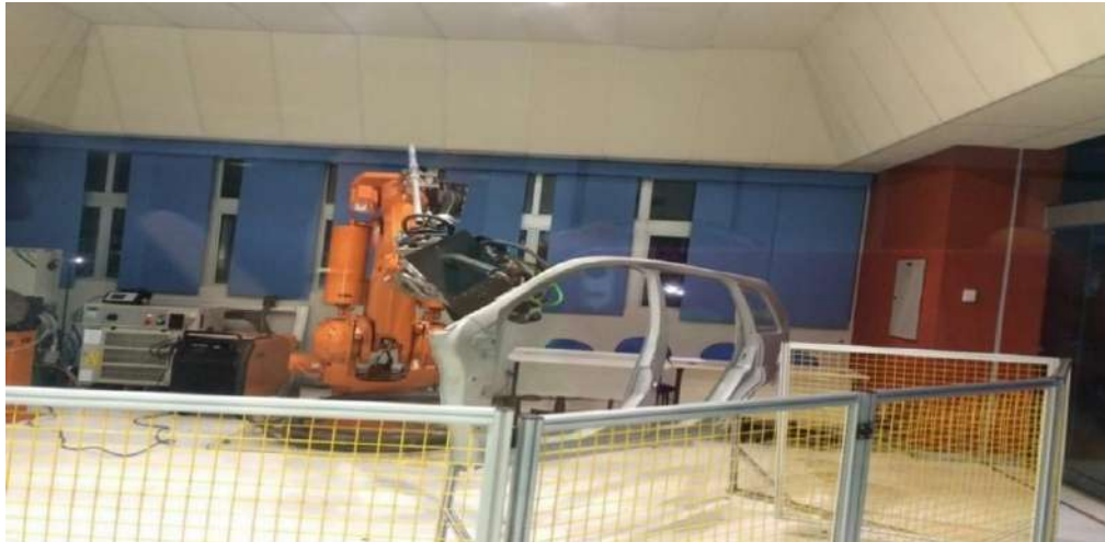
Figura 2: Robô de 6 eixos IRB 6400 ABB (pode ser utilizado para manipulação de materiais industriais, soldadura por pontos).
