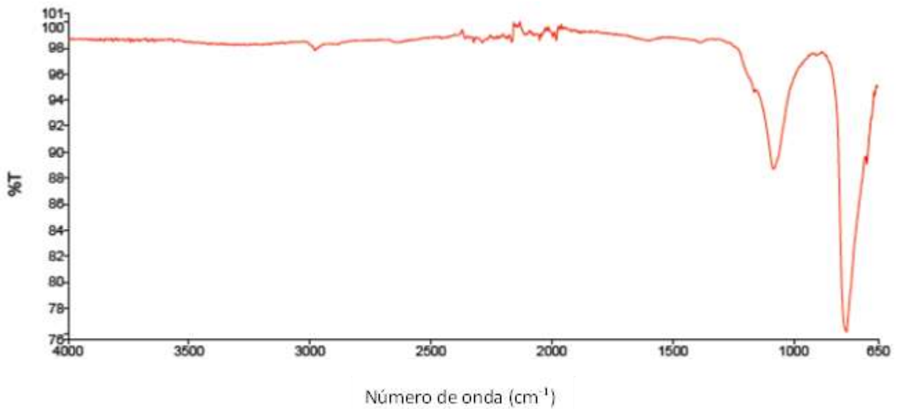
Figura 16. Espectro de infravermelho de sedimentos do 4º ponto de coleta (Rio Barroso Foz) (Coleta de 25/09/2021)
