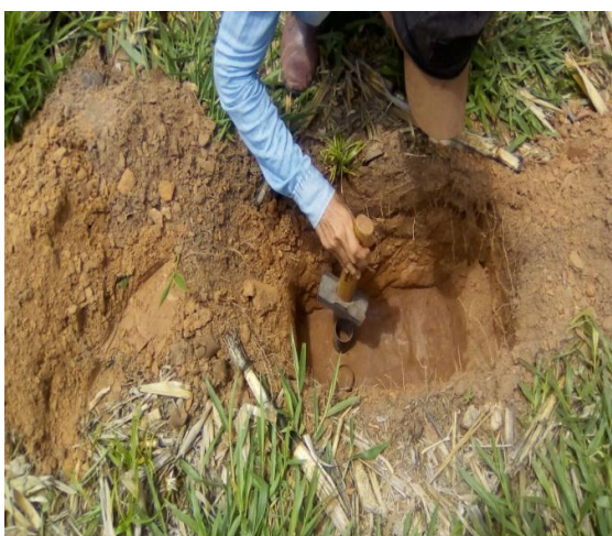
figura 02 Coleta de solo: amostras deformadas e indeformadas.
