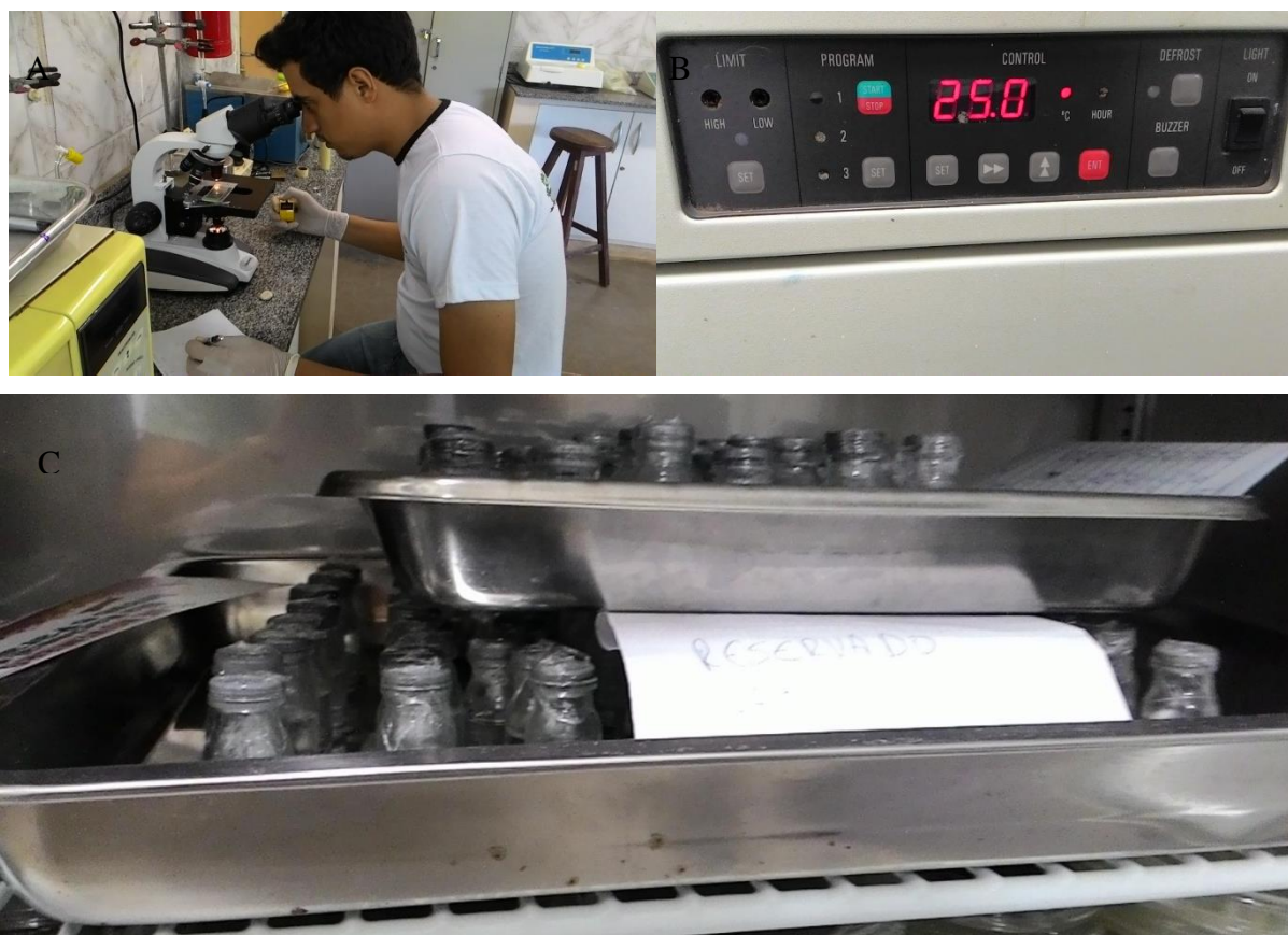
Figura 5 - Contagem dos J2 eclodidos em microscópio estereoscópico (A), temperatura constante da BOD a 25°C (B) e acomodação dos vidros de penicilina no interior da BOD (C)
