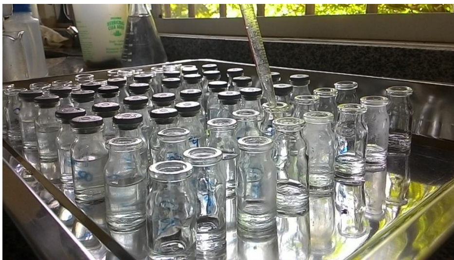
Figura 3 - Vidros de penicilina autoclavados e identificados sendo adicionado as diluições do produto com uma pipeta.
