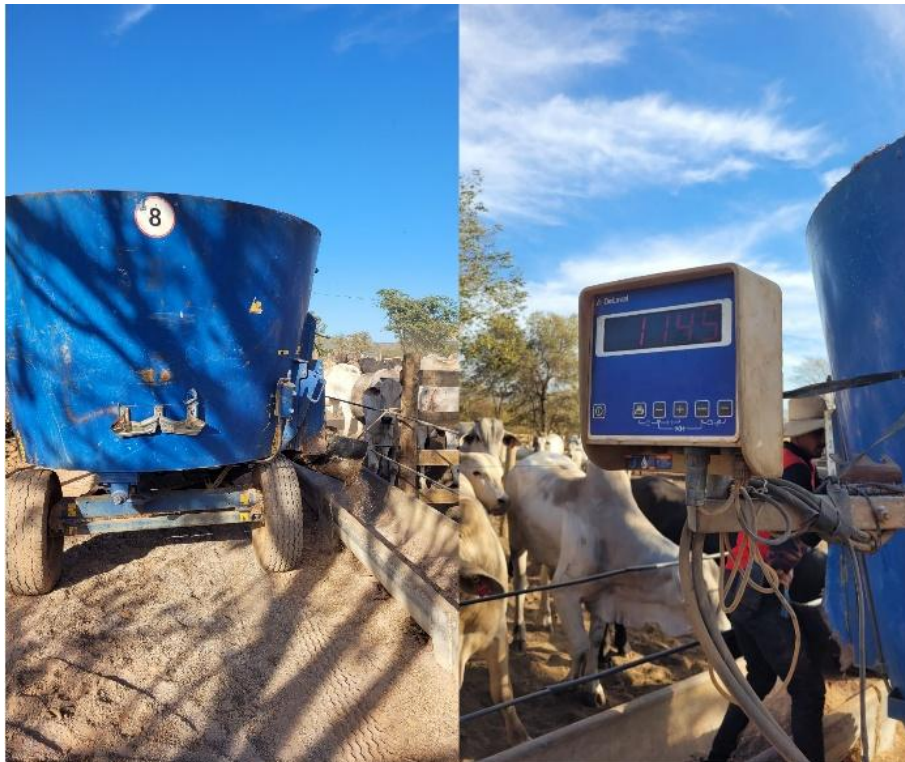
Figura 4. Vagão misturador e balança digital durante o fornecimento da ração, garantindo registro preciso das quantidades e uniformidade da mistura. (Fonte: Arquivo pessoal).
