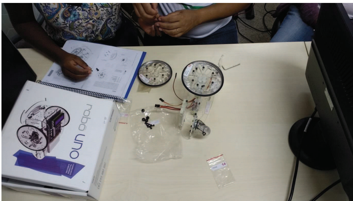
Figura 19 - Processo de montagem da roda no chassi do robô UNO
