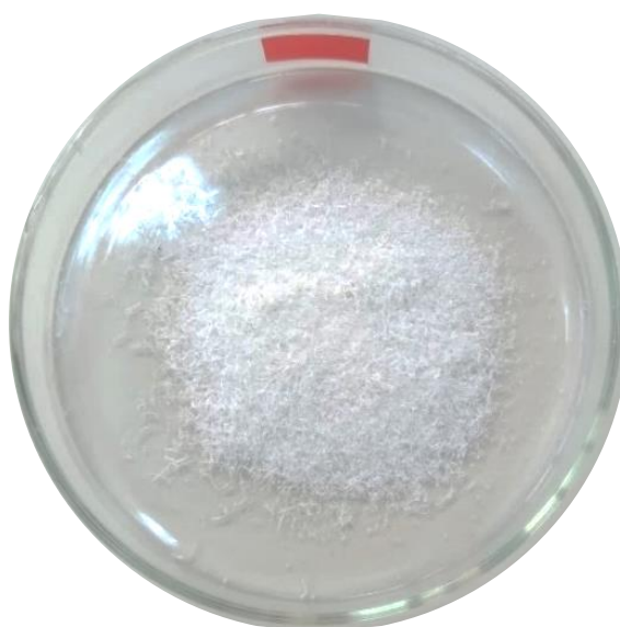
Figura 15 – Bioplástico a base de PLA, o copo de 200 mL após lavado, triturado e tamisado a 40 mesh
