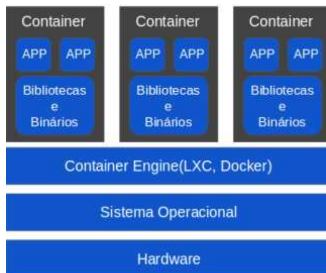
Figura 1 - Virtualização utilizando Containers
