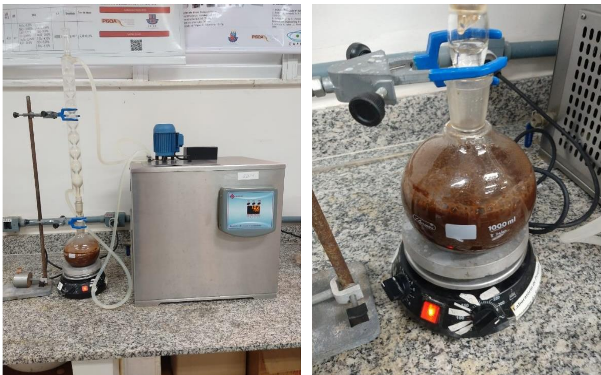
Figura 10: Sistema de extração com refluxo acoplado a banho termostático e balão
