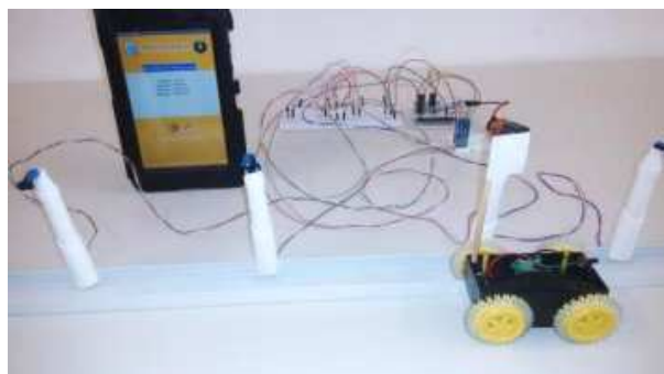
Figura 5 – Aparato Robótico para o estudo do MRU
