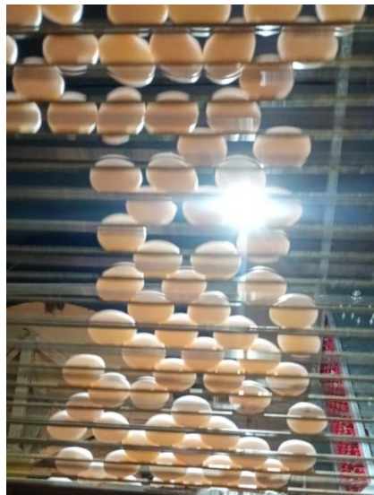
Figura 6 - Esteira de transporte de ovos para setor de beneficiamento. Fonte: Arquivo Pessoal.
