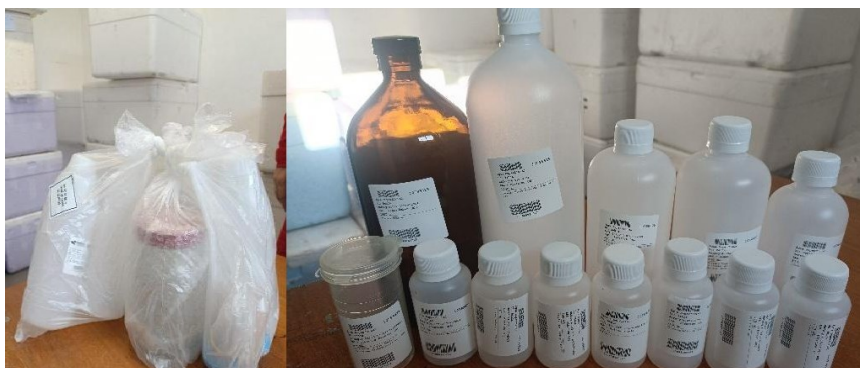
Figura 5 – Separação da frascaria para as amostras contendo os códigos referentes aos parâmetros avaliados para qualidade da água nos pontos de entrada e saída da lagoa de estabilização.
