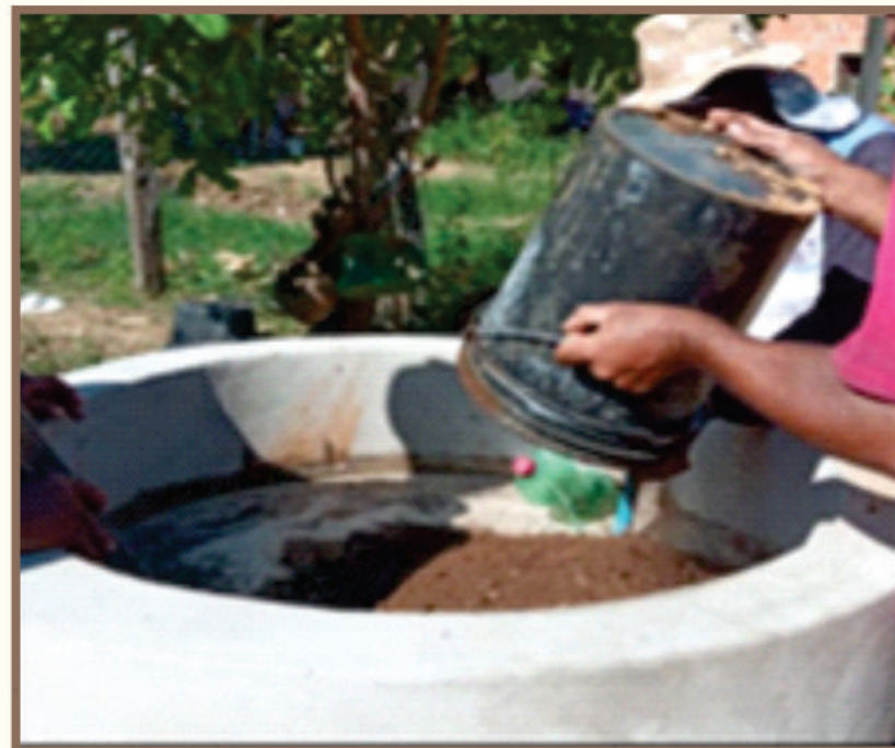
Figura 33 abastecimento do biodigestor com esterco fresco
