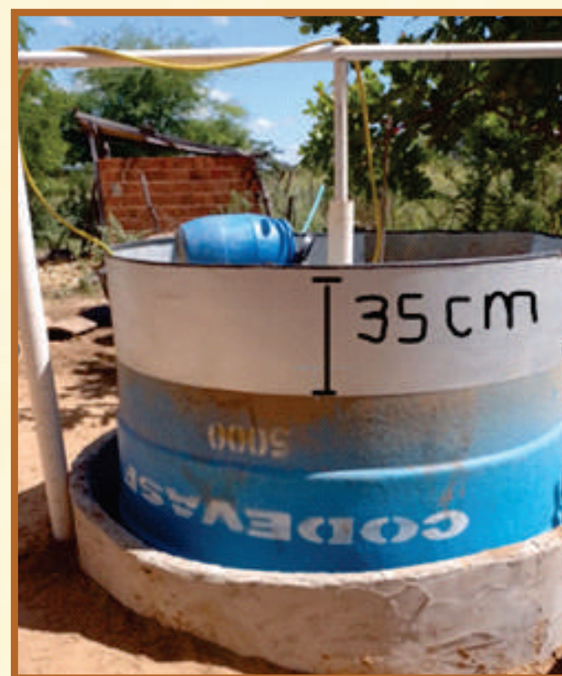
Figura 25 - anel de zinco sobre a caixa/ reservatório de gás
