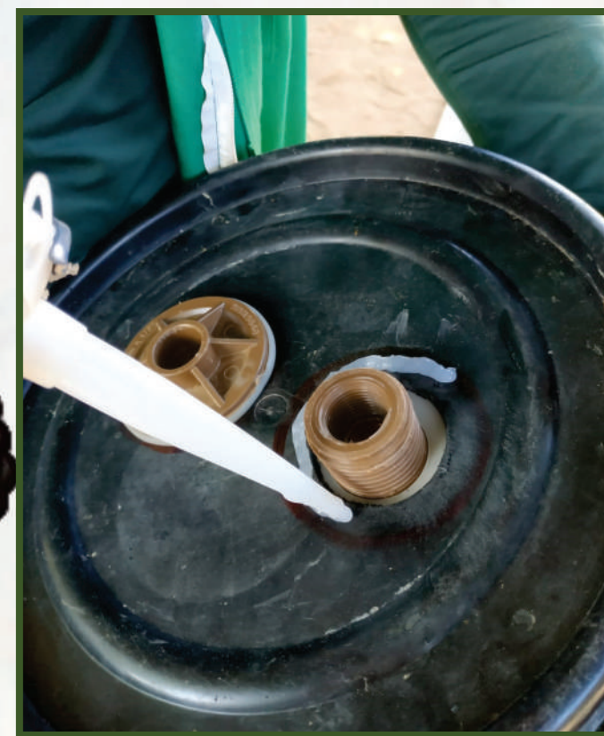
Figura 27 - fixação dos flanges na tampa da bombona
